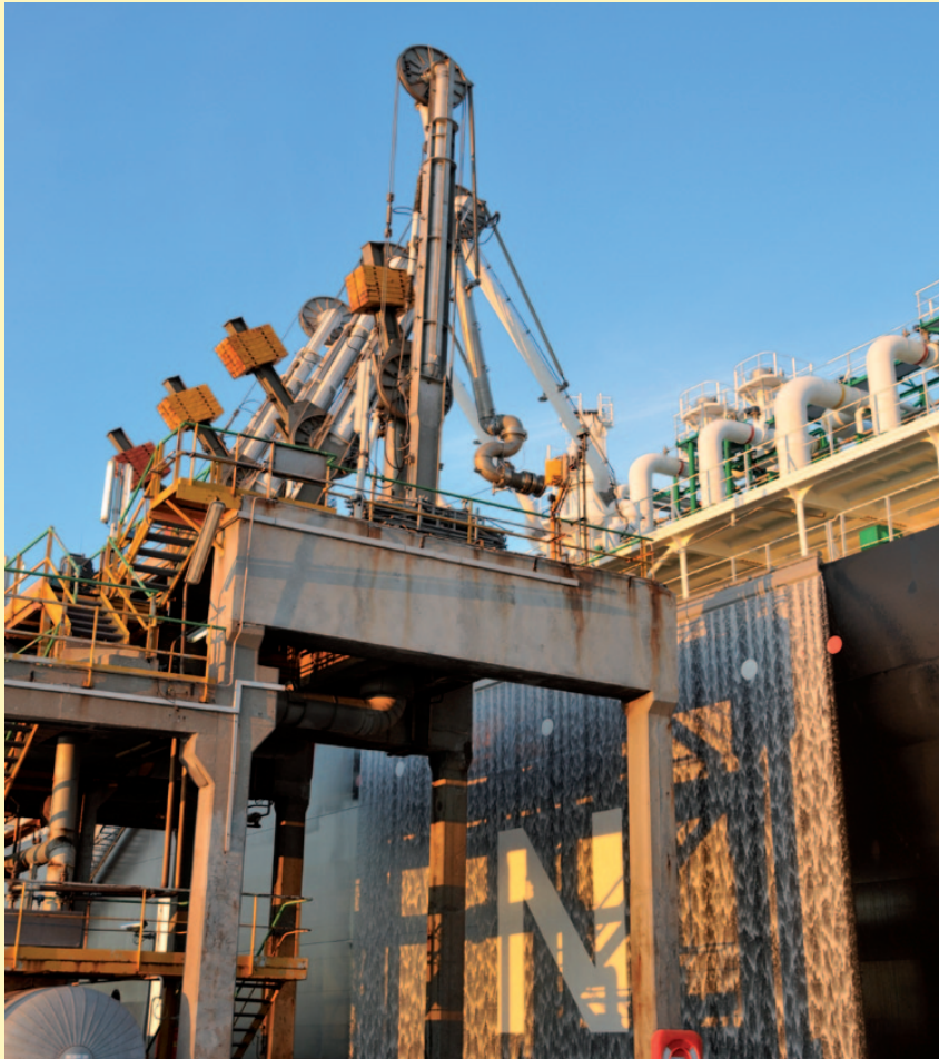
Film d'eau de protection de la coque du navire sous les bras de déchargement
