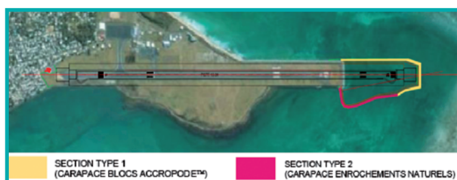
Scénario 1 Etape 1 – Plan des protections maritimes (ADPi-SOGREAH, 2010)
