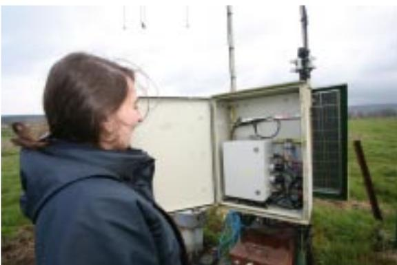
Contrôle des piézomètres (mesure du niveau d'eau)
