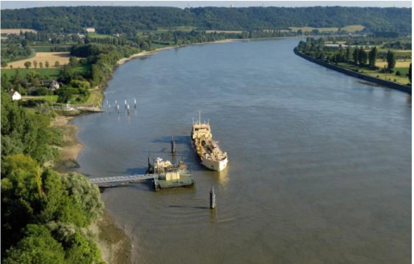
Drague aspiratrice en marche et installation de refoulement des sédiments jusqu'à la ballastière
