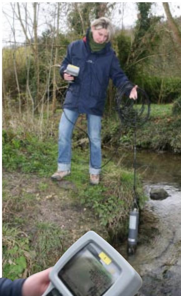
Mesure par sonde physico-chimique de la qualité de l'eau
