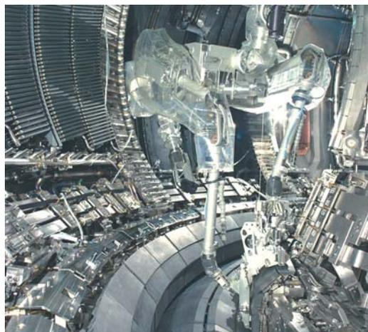
*Intervention d'un robot dans le JET. L'un des défis d'ITER consiste à devoir se passer de l'intervention humaine à l'intérieur de la machine. Plusieurs robots sont en cours de développement pour des opérations diverses.*
