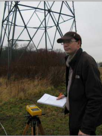
Bernard Tavernier (à gauche) vérifie les mesures de champ magnétique pour le nouveau site de la ligne à très haute tension.
