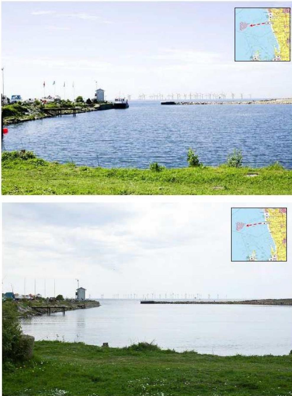
Figure 6 : Comparaison réel / virtuel sur un des photomontages réalisés pour l'étude d'impact sur le site éolien de Lillgrund (Suède). L'image réelle est en bas, la simulation au-dessus. Les éoliennes sont situées à 5,3 km du littoral. On notera l'excellente concordance globale, mais une visibilité moindre dans le cas réel, due à des facteurs atmosphériques.
