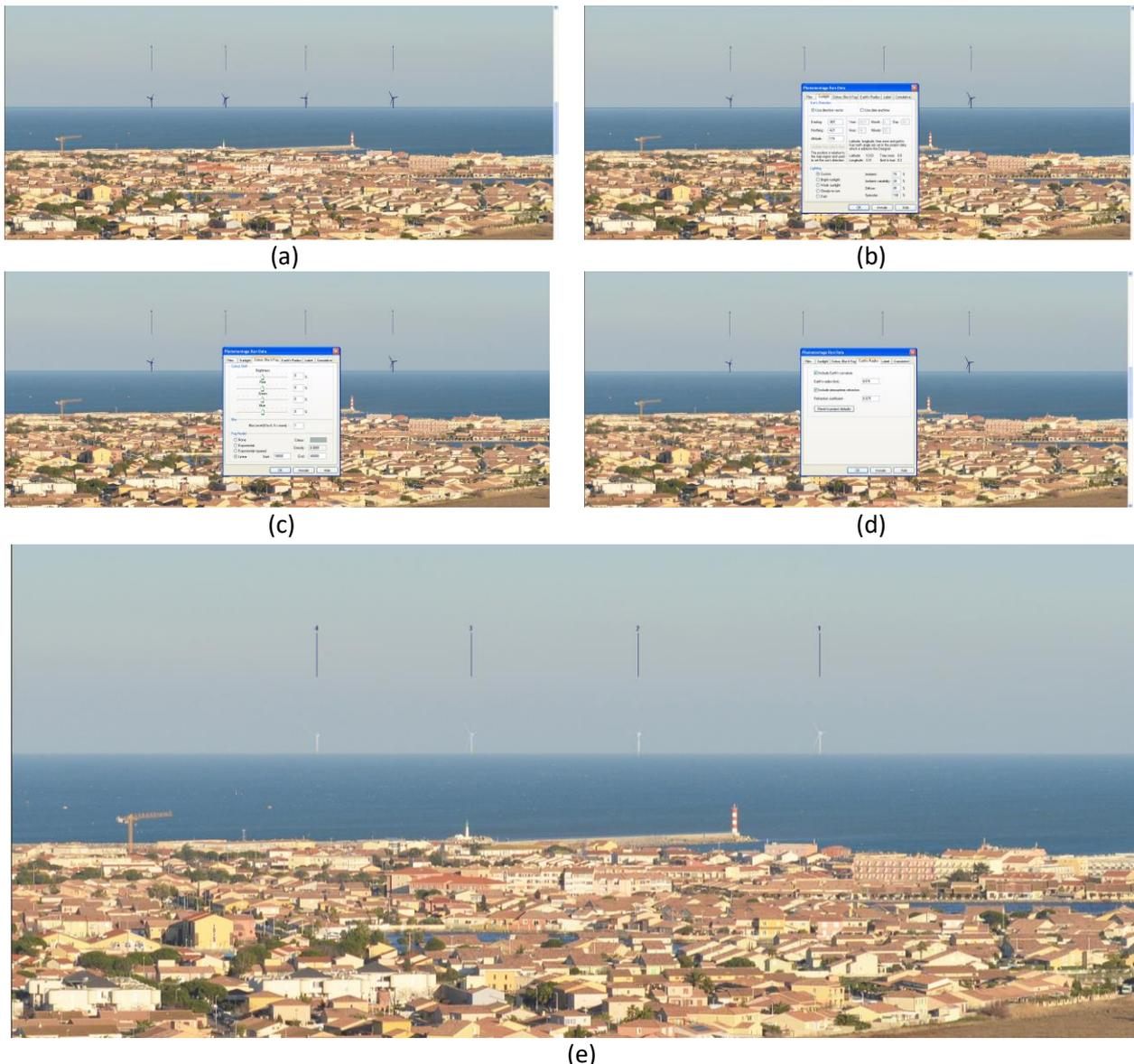
**Figure 20 : Phase de rendu visuel dans WindFarm pour le projet EolMed-Gruissan : (a) rendu « fil de fer », permettant de valider l'allure globale. (b) On règle la position et l'intensité de l'éclairage solaire. (c) Un facteur d'atténuation est réglé pour simuler la variation de visibilité en fonction de la zone. (d) ajustement de la courbure terrestre et de l'indice de réfraction atmosphérique (e) Rendu final dans Windfarm avant retouches.**
