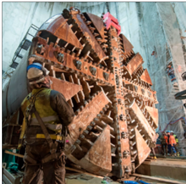
EXEMPLE D'UN TUNNELIER UTILISÉ POUR CREUSER LE TUNNEL DU MÉTRO (LIGNE 14 DU MÉTRO PARISIEN) ©G. ROLLANDO
