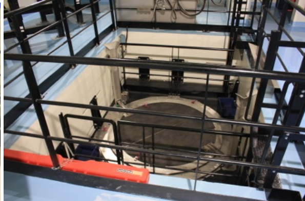
A gauche, dispositif servant à déplacer les déchets de la zone d'arrivage vers la zone de traitement et à les sortir de leur emballage de transport. A droite, sas de transfert des déchets hors de leur emballage de transport.
