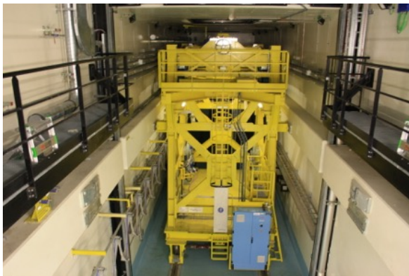
A gauche, dispositif servant à déplacer les déchets de la zone d'arrivage vers la zone de traitement et à les sortir de leur emballage de transport. A droite, sas de transfert des déchets hors de leur emballage de transport.
