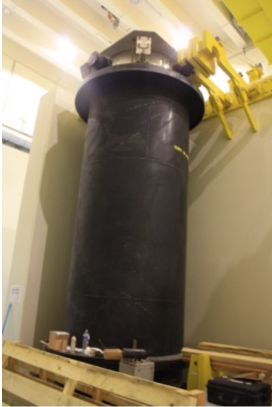
Emballage TN de déchets longs. Il fait 4m de haut et 115 tonnes.
