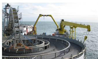
Un navire câblé est utilisé pour dérouler le câble en mer
