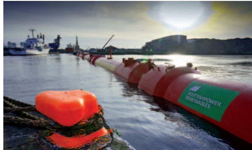
/// Convertisseur Pelamis (système houlomoteur, projet porté par IBERDROLA)
