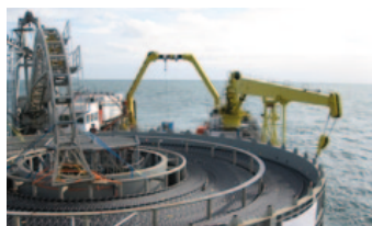
Un navire câbleur est utilisé pour dérouler le câble en mer
