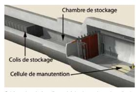
Schéma de principe d'une alvéole de stockage de colis de déchets MA-VL.
