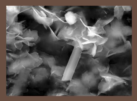
Argile vue au microscope électronique à balayage.
