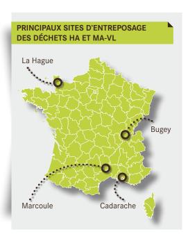
Dans l'attente de la mise en service de Cigéo, les colis de déchets HA et MA-VL déjà produits sont provisoirement entreposés à sec dans des bâtiments sur leur site de production, principalement à La Hague (Manche), Marcoule (Gard), Cadarache (Bouches-du-Rhône) et, pour un volume limité, à Valduc (Côte-d'Or). Une installation d'entreposage pour certains déchets issus de l'exploitation et du démantèlement des réacteurs est en cours de construction sur le site de Bugey (Ain).
