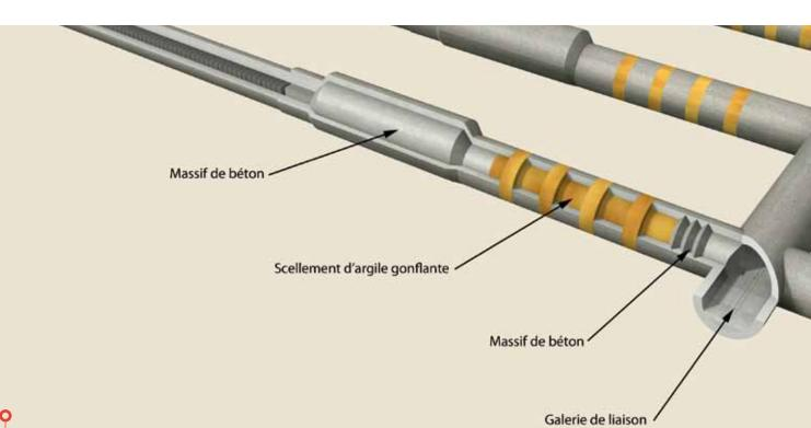
Principe de fermeture d'une alvéole de stockage MA-VL.
