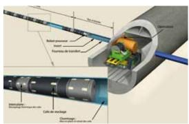
Schéma de principe d'une alvéole de stockage de colis de déchets HA
