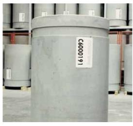
Colis béton de déchets MA-VL (1 m 50 de hauteur, 1 m de diamètre, ~ 2 tonnes).
