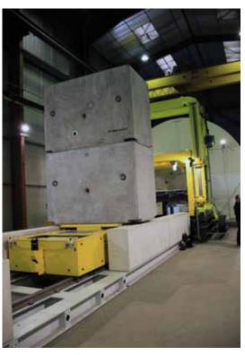
Essai de mise en place et de retrait de colis de stockage de déchets MA-VL.
