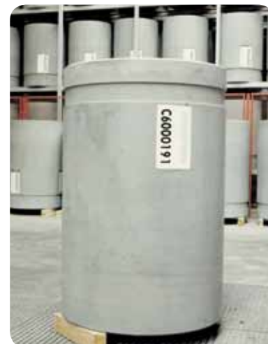
Colis béton de déchets MA-VL (1 m 50 de hauteur, 1 m de diamètre, ~ 2 tonnes).
